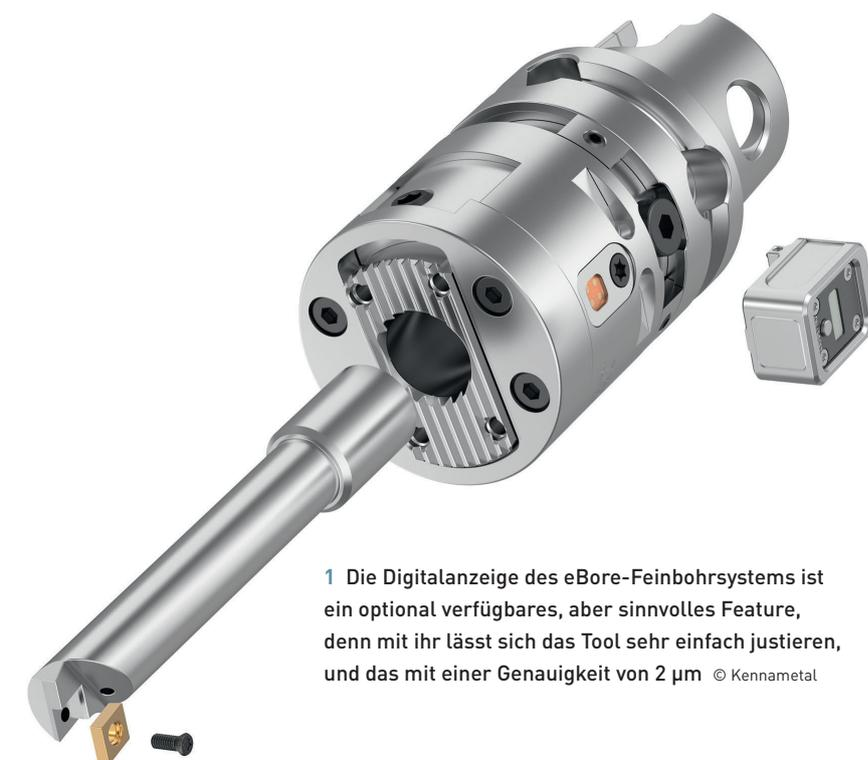
1 Die Digitalanzeige des eBore-Feinbohrsystems ist ein optional verfügbares, aber sinnvolles Feature, denn mit ihr lässt sich das Tool sehr einfach justieren, und das mit einer Genauigkeit von 2 µm © Kennametal
